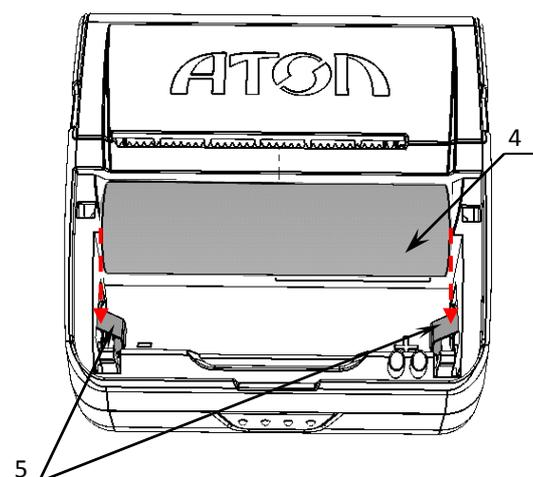
Рисунок 5. Установка аккумулятора
