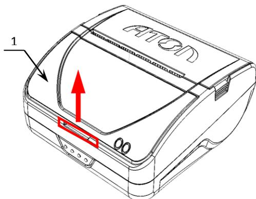
1. Аккуратно надавить на крышку отсека **1** в области прорези в направлении «снизу–вверх».
