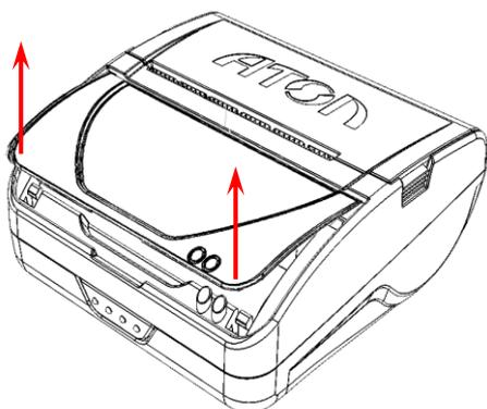
2. Приподнять переднюю часть крышки.
