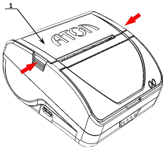
1. Надавить на фиксаторы крышки лотка для ЧЛ **1** в направлении показанном на рисунке, освободить крышку.
